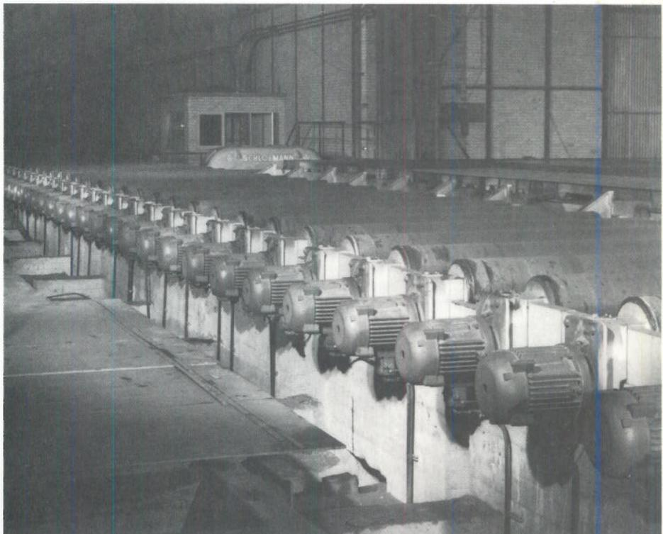
Bild 3.2 Grobblechstraße mit Getrieberollen 350 mm  $\varnothing$ , 3400 mm lang, mit angebauten 10poligen Rollgangs-Motoren, Anzugsmoment an der Läuferwelle 80 Nm (8 kpm)
