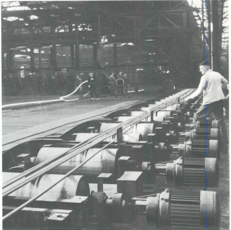
Rollgangs-Getriebe-Motoren an einem Knüppel-Rollgang bei der Dortmund-Hörder Hüttenunion AG, Dortmund
