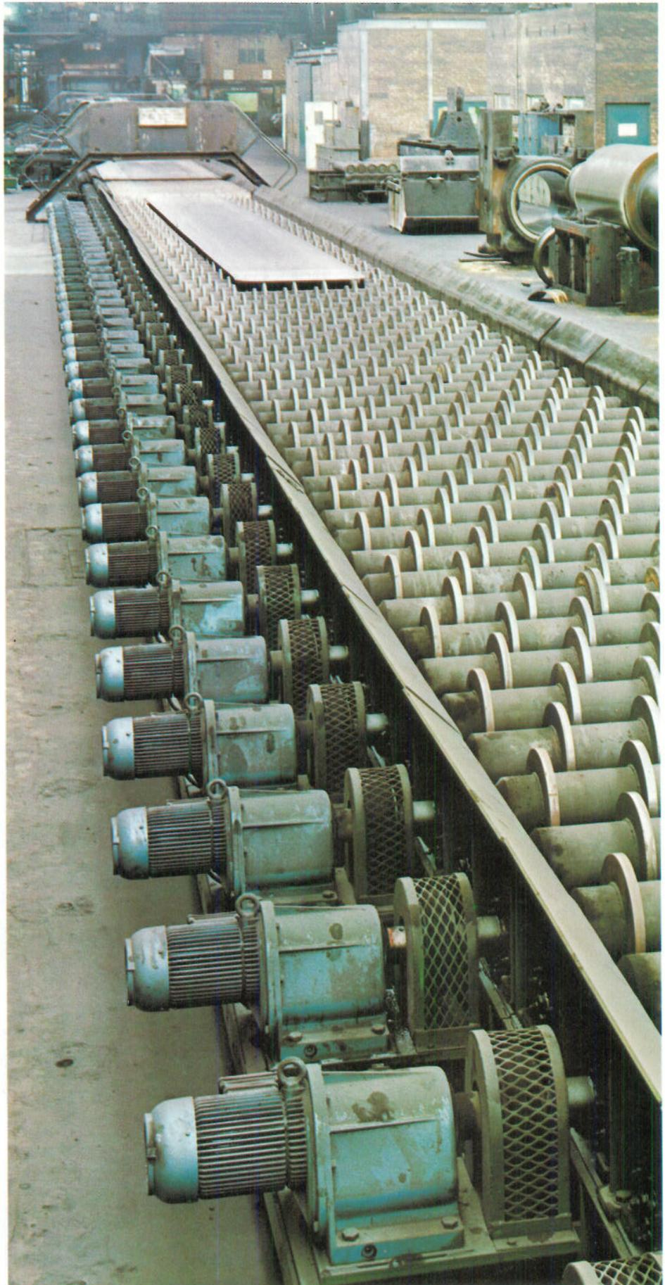
Bild 2.3 Scheibenrollgang mit Rollgangs-Getriebe-Motoren und abgedeckter Kupplung bei PATENT SHAFT STEEL COMPANY LTD.
