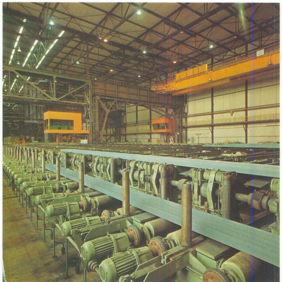
Rollgangantriebe mit Abdeckung am
