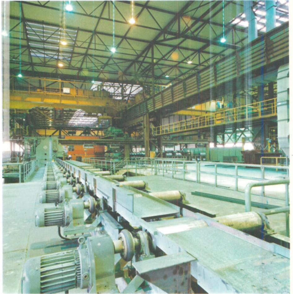
Bild 16.2.7 Frequenzgesteuerter Rollgang hinter der Richtmaschine mit Drehstrom-Getriebe-Motoren, Anzugsmoment 250 Nm, Drehzahl 87 ... 800/min, Frequenz 12 ... 110 Hz, Transportgeschwindigkeit 1,2 ... 11 m/s in der UMIT bei den Stahlwerken PEINE-SALZGITTER AG
