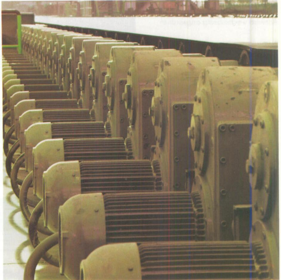
Rollgangs-Getriebe-Motoren mit 6 Hz-Pendelgang an einem Kühlbett für Grobbleche (ITALSIDER, Taranto, Italien)
