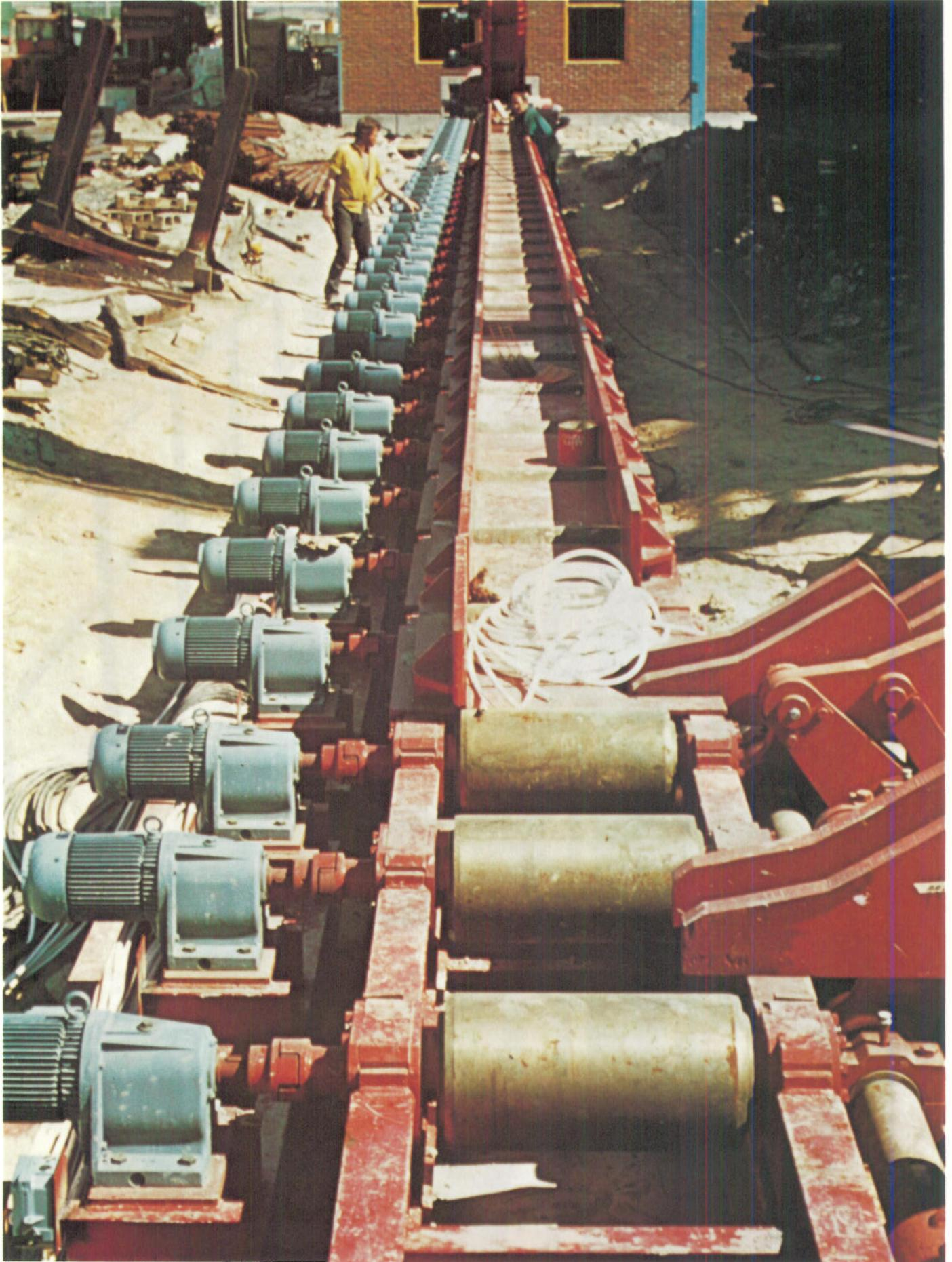
Installation von Rollgangs-Getriebe-Motoren an einem Knüppel-Rollgang bei ISMEDJEBACKENS VALSVERKS AB, Schweden)
