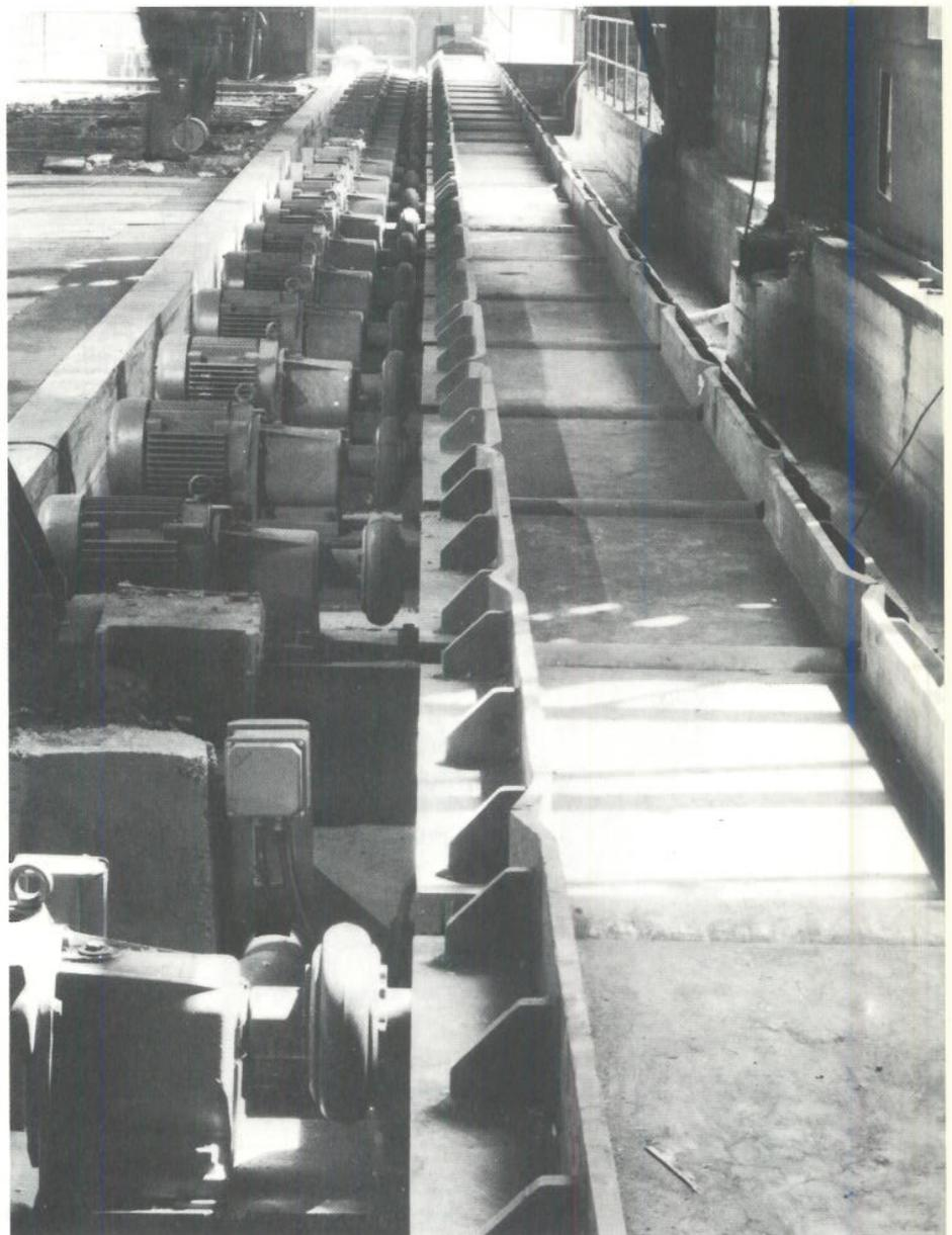
Bild 2.2 Rollgangs-Getriebe-Motoren mit hochelastischer Kupplung an einem Knüppel-Scheren-Rollgang
