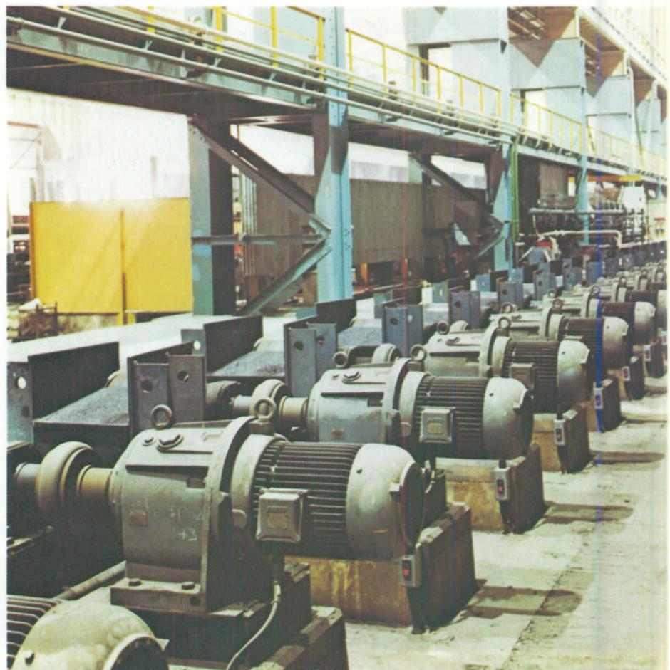
Drehstrom- und Gleichstrom-Rollgangs-
