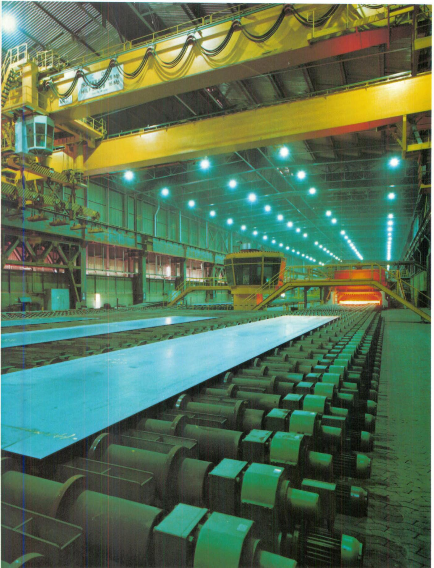
Rollgangs-Motoren mit Flachgetriebe in Sonderkonstruktion zum Antrieb von Scheibenrollen über Torsionsstab im Umrichterbetrieb 4 bis 120 Hz bei DILLINGER HÜTTENWERKE.
