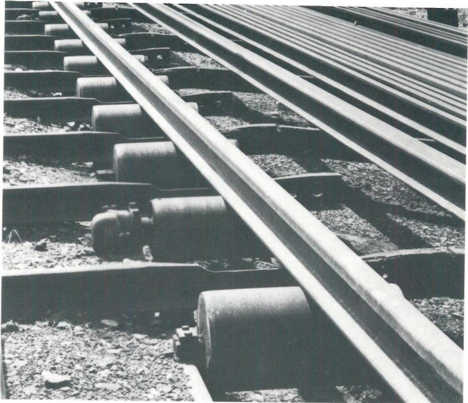
Bild 5.2 Trommel-Motoren in Sonderausführung zum Transport von Eisenbahnschienen in einem Gleislager der Bundesbahn
