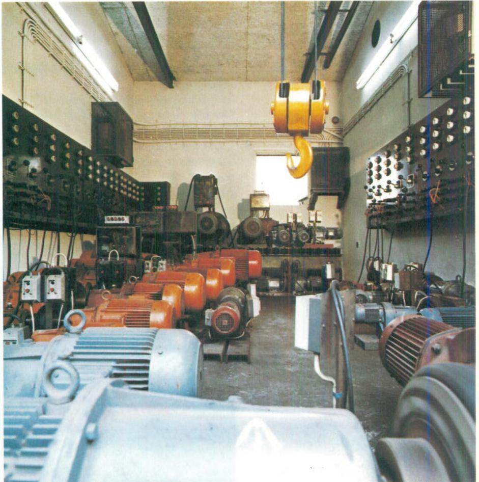
Bild 18.3 Teilansicht der Dauerversuchsräume zur Lebensdauerprüfung von Getriebe-Motoren
