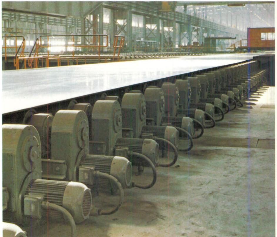
Bild 4.1.2 Aufsteck-Rollgangs-Getriebe-Motoren mit Hohlwelle und einfacher Drehmoment-Abstützung bei ITALSIDER, Taranto/Italien
